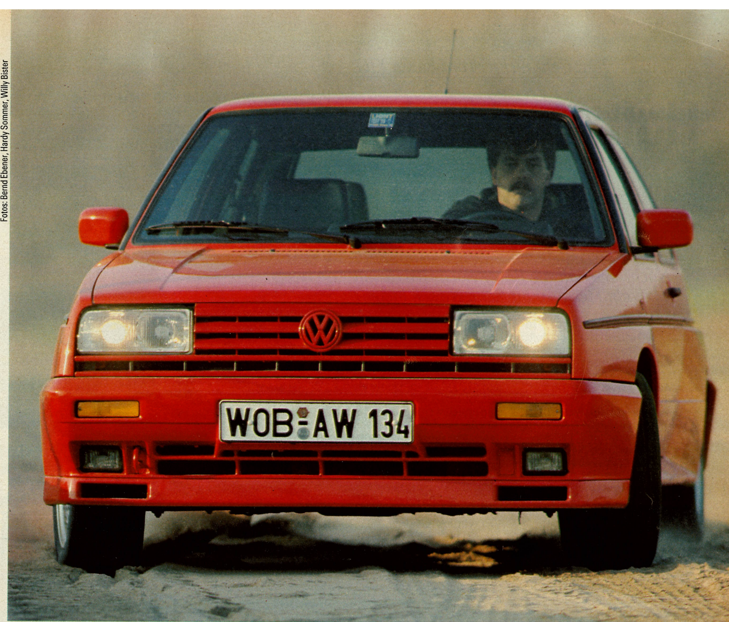
Allradantrieb mit Visco-Kupplung verleihen dem Rallye-Golf auf losem Untergrund eine ausgezeichnete Traktion.
