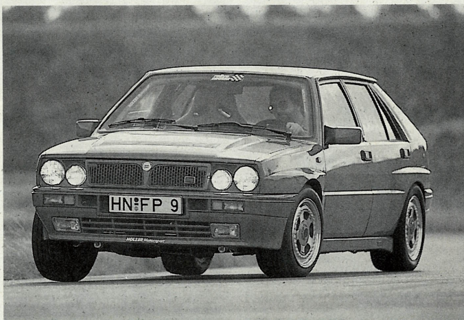
Oben: Kaum Seitenneigung durch straffes Sportfahrwerk beim Lancia. Unten: Bildhübsch – das dreiteilige Le Mans-Rad
